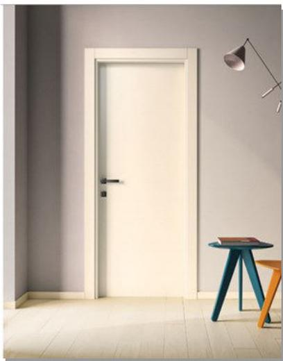
Le porte interne sono costituite da un telaio perimetrale in legno duro, tamburate con pannelli in MDF, riempite con alveare in cartoncino e racchiuse dal rivestimento di finitura. Le porte saranno dotate di maniglie e di serrature cromo satinato e rivestite in laminato bianco come il battiscopa delle stanze. Lo stipite è in legno listellare bordato su tre facce con guarnizione in gomma sulla battuta. Le porte saranno nelle misure standard 70/80 cm x 210 cm, bianche ad un'anta.
